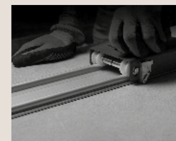
Cutting detail with guide on slab. Detalle de corte con guía sobre plancha.
