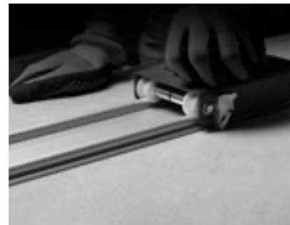
Cutting detail with guide on slab. Detalle de corte con guía sobre plancha.
